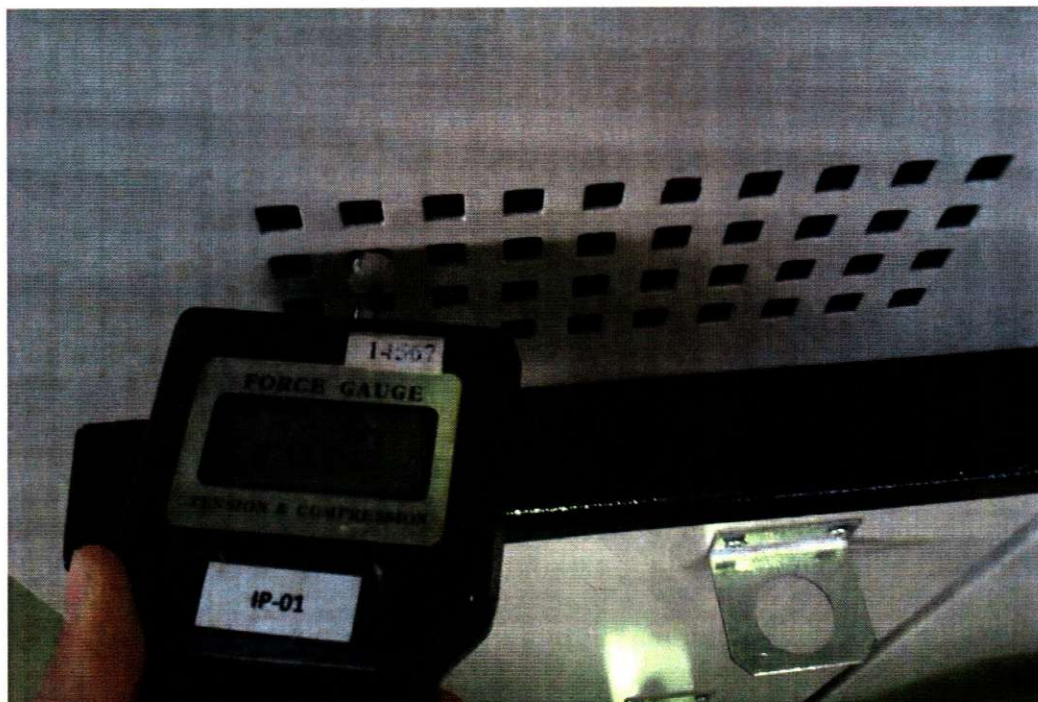
تصویر ۲: تجهیز در تست IP2X
